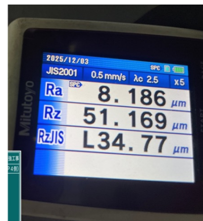
Surftest SJ-210（触針式表面粗さ測定方式）
